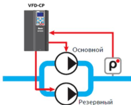
В данном режиме в один момент времени работает только один насос в режиме поддержания давления. Переключение насосов производится по времени для равномерного износа.
