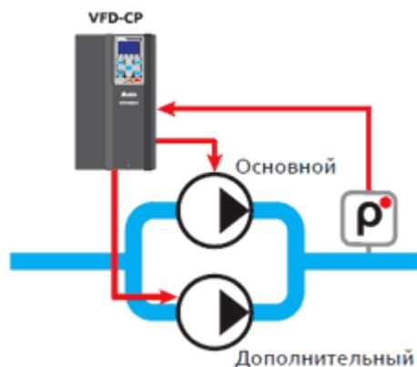
В данном режиме частотный преобразователь регулирует обороты одного насоса с целью поддержания давления. В случае нехватки производительности одного насоса ПЧ подключает основной насос напрямую от сети и начинает регулировать обороты дополнительного насоса.
